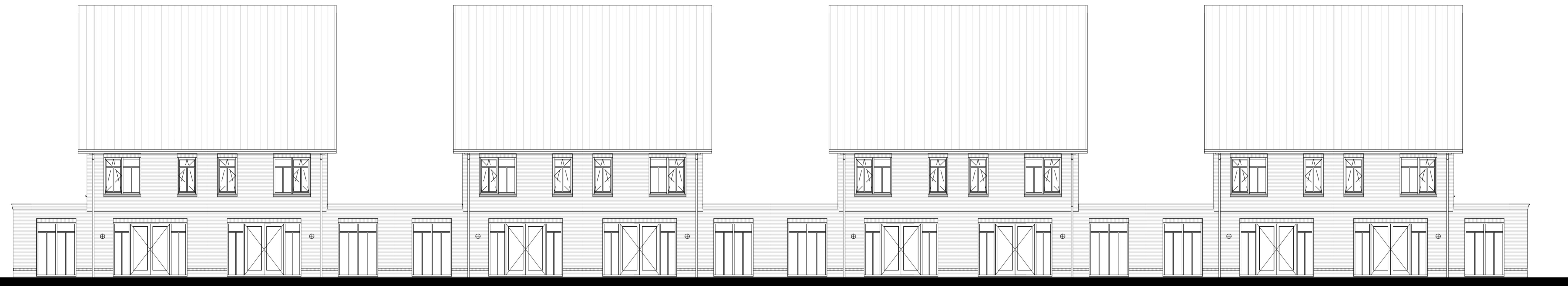
2 Achtergevel 1:100 Type C1s bnr: 115 Type C2 bnr: 116 Type C1s bnr: 117 Type C2 bnr: 118 Type C2s bnr: 119 Type C1 bnr: 120 Type C2s bnr: 121 Type C1 bnr: 122 metalsteen 3, kleur: wit gemêleerd metalsteen 3, kleur: wit gemêleerd metalsteen 1, kleur: geel gemêleerd metalsteen 1, kleur: geel gemêleerd metalsteen 1, kleur: geel gemêleerd metalsteen 1, kleur: geel gemêleerd metalsteen 1, kleur: geel gemêleerd metalsteen 1, kleur: geel gemêleerd
